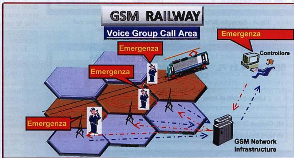
Fig. 6 - Suddivisione delle tratte ferroviarie in aree predefinite per la gestione del sistema della rete GSM-R
