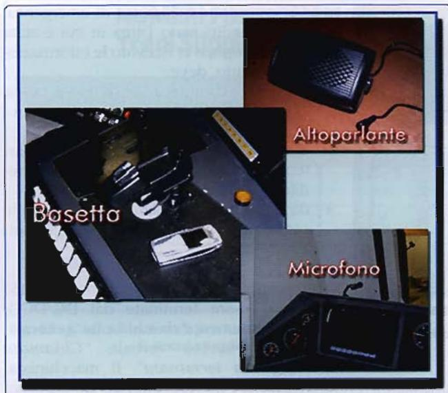
Fig. 17 - Kit Veicolare di supporto per cellulari Sagem installato su Loc. E. 464
