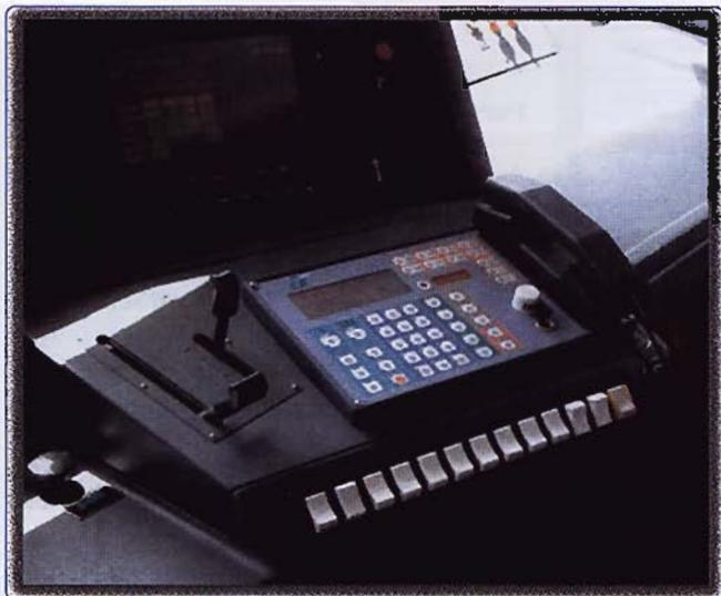
Fig. 5 - Pulsantiera Integrata di Bordo per radio comunicazione a 900 MHz e a 450 MHz, installata su convogli di nuova generazione TAF
