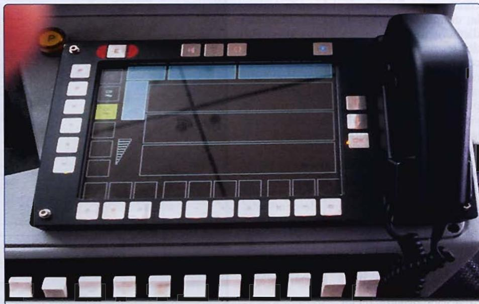
Fig. 18 - Apparato CAB-Radio installato sulla flotta dei treni di ultima generazione denominati "Vivalto"
