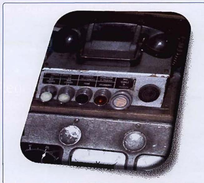
Fig. 3 - Posto Operatore PdC del telefono terra treno ad onde convogliate tipo TEF, di prima generazione, installato su Loc. E. 646
