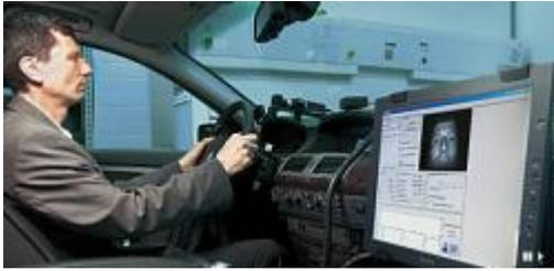
quando il conducente prende posto al volante e guarda attraverso il parabrezza, una telecamera integrata nella vettura si focalizza sui suoi occhi. La telecamera segue automaticamente i movimenti della sua testa e registra, per esempio, il movimento degli occhi durante una manovra.
